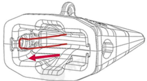
**3.3** Presionar ligeramente ambos extremos del retenedor metálico y girarlos hacia la 2ª ranura (lado interno) para dejar que ambos extremos se anclen dentro de la ranura.
