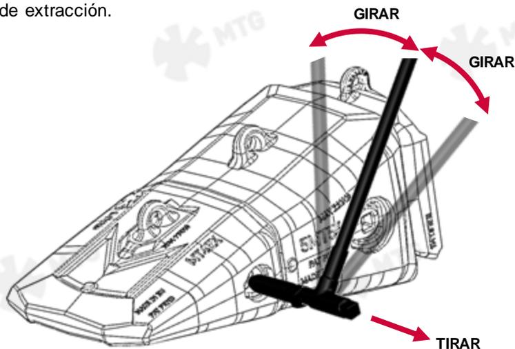
**4.1.3** Repetir los pasos anteriores 4.1.1 y 4.1.2 con el pin del otro lado.
