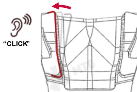
**2.4** Si es necesario, deslizar el wear cap antes de instalar el diente.
