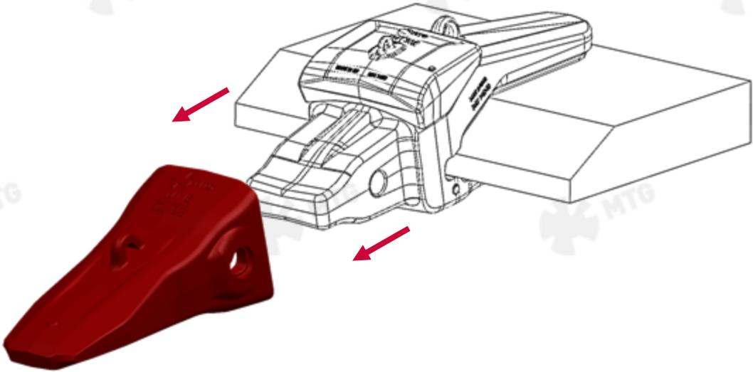
**3.2** Retire la cubierta de desgaste del adaptador.
